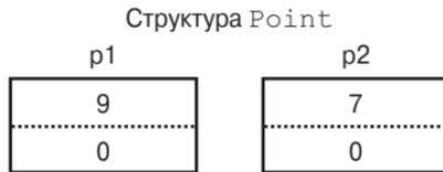
**Рис. 2.** Присваивание копирует экземпляр типа-значения
